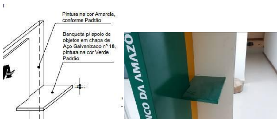
Detalhe da banqueta de apoio em chapa metálica
