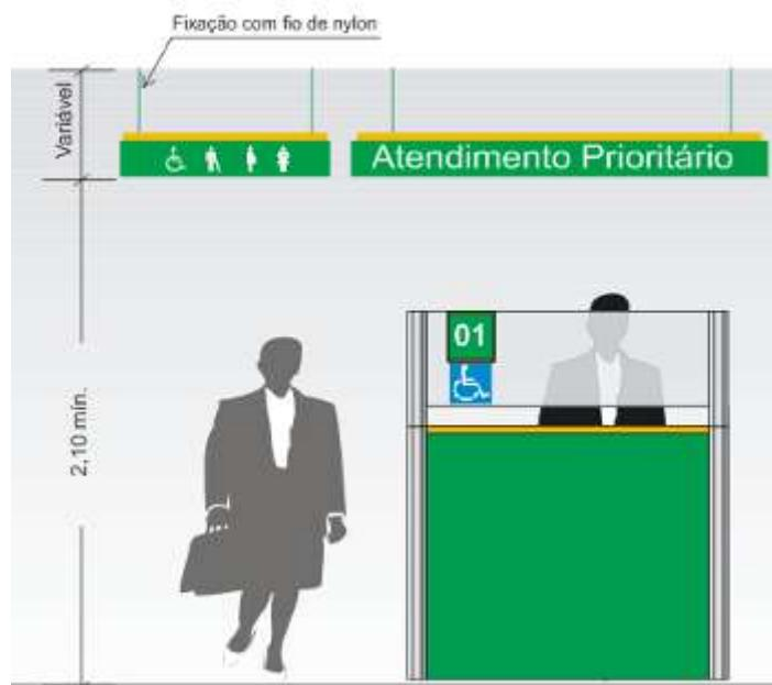
**Aplicação do conjunto de Placas Aéreas - Vista Esquemática**
